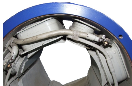
Obr. 4.1: Budící vinutí stejnosměrného stroje
