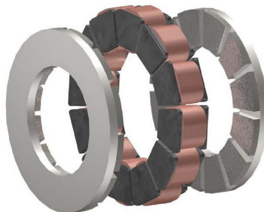
Obr. 12.8: Uspořádání stroje YASA
