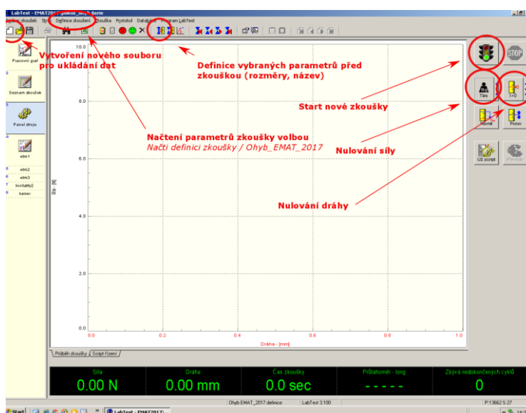
Obr. 6: Okno softwaru pro ovládání univerzálního zkušebního stroje a pro záznam zkoušek.
