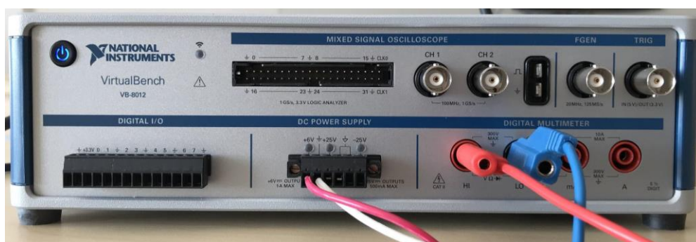
Obr. 3: Čelní panel měřicí stanice při využití zdroje a voltmetru.
