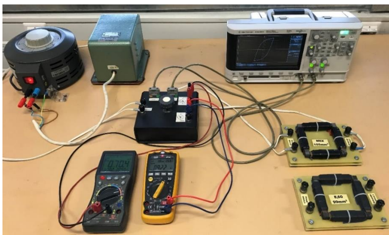
Obr. 2: Reálné provedení zapojení pro měření magnetických ztrát z hysterezní smyčky.
