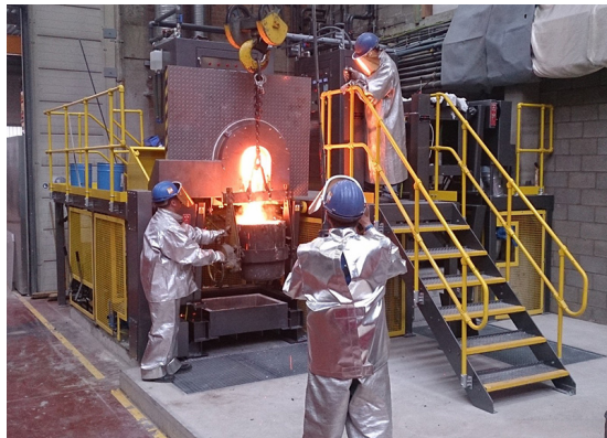
Indukční tavící kelímek v Belgii - https://www.induction-furnaces.com/
