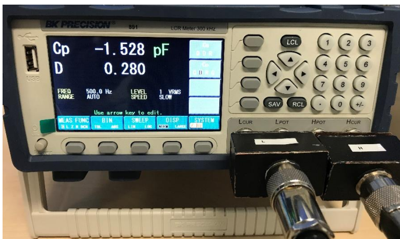
Obr. 4: Čelní panel RLC můstku při zobrazení požadovaných hodnot C_p a D .
