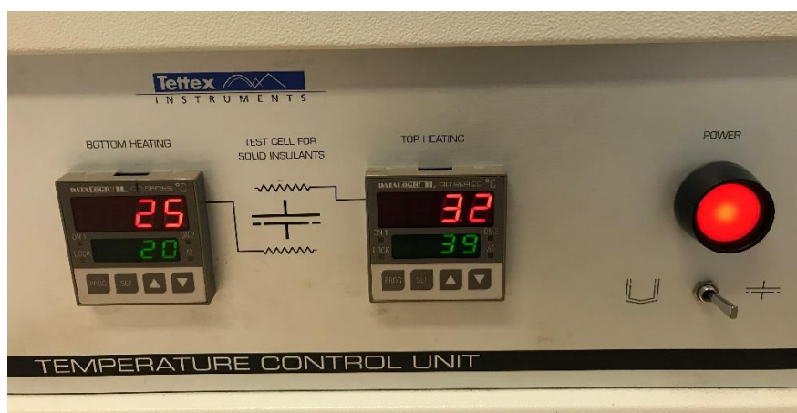
Obr. 3: Detail ovládání teploty elektrod.
