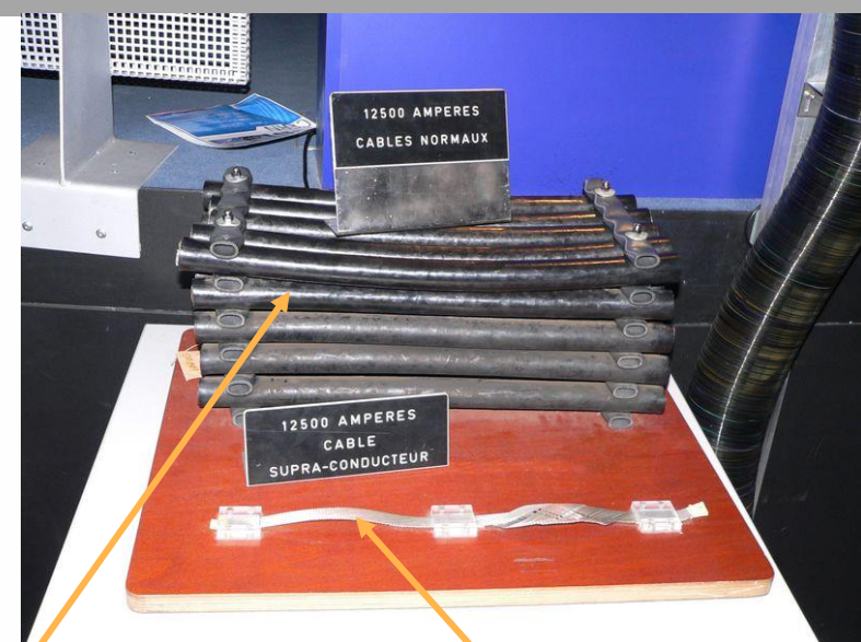
Supravodivý pásek dimenzovaný na 12,5 kA.
