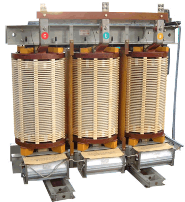
Suchý distribuční transformátor izolovaný Nomex papírem (teplotní třída H, tj. 180 °C).
