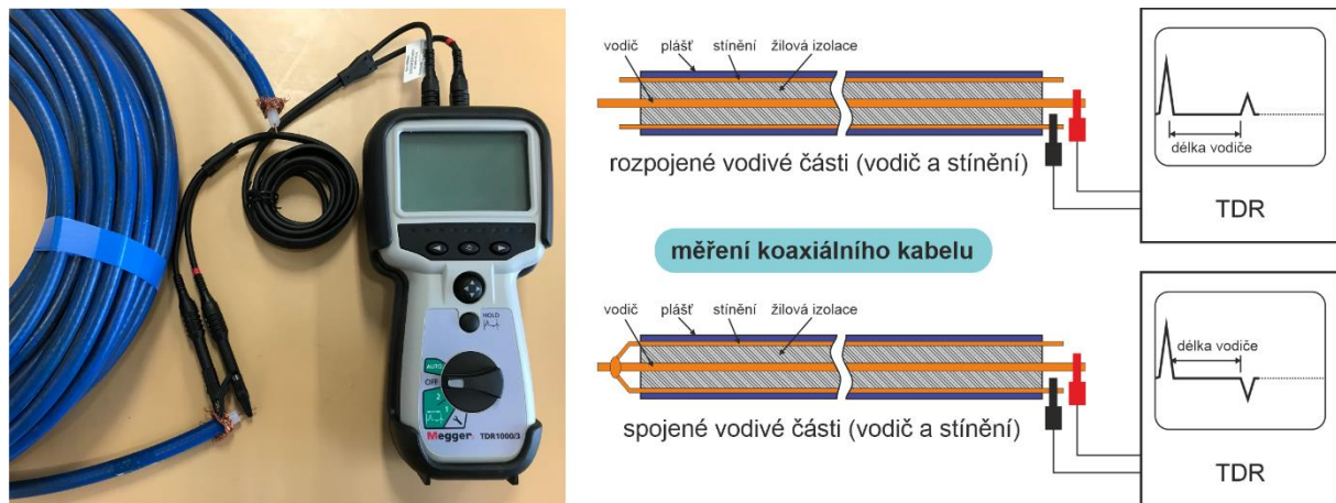
Obr. 3: Reálné připojení reflektometru k diagnostikovanému koaxiálnímu kabelu společně se schematickým znázornění odezvy TDR na stav rozpojení a stav zkratování vodiče a stínění.
