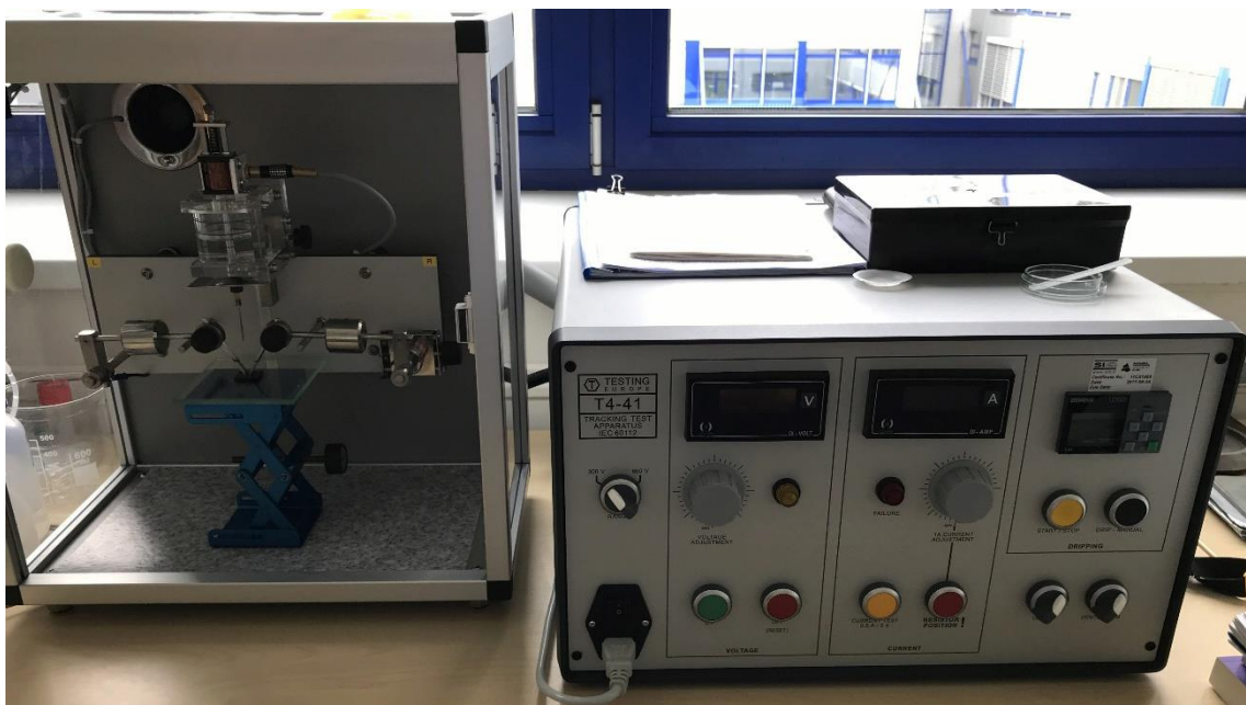
Obr. 1: Aparatura pro určování odolnosti materiálů vůči plazivým proudům (napájecí a ovládací jednotka vpravo, odvětrávaná komora vlevo).
