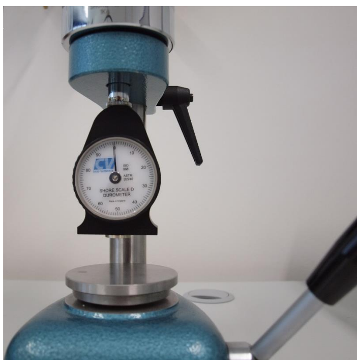
Obr. 2: Tvrdoměr se stupnicí Shore D na stojanu se závažím o hmotnosti požadované normou.
