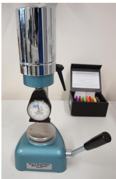
Obr. 2: Tvrdoměr se stupnicí Shore D na stojanu se závažím o hmotnosti požadované normou.
