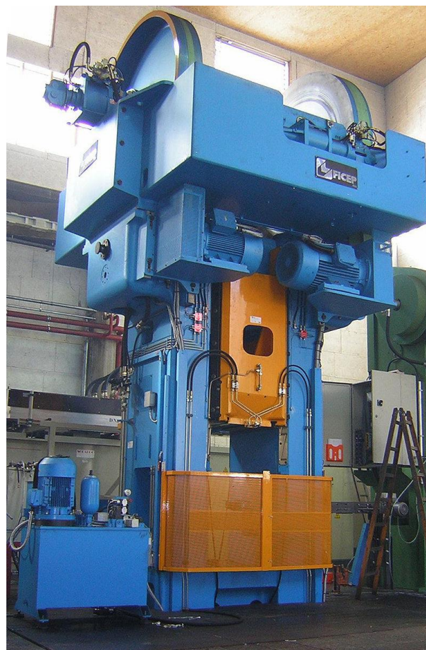
Vřetenový lis diskový, jmenovitá síla 13.000 kN, Průměr vřetena 360 mm
