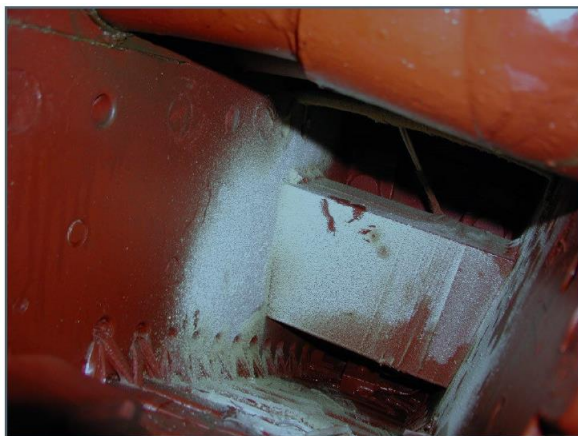
Obr. 2.3: Izolace ve formě bílého prachu, sedřená z čel vinutí třením a vibracemi (vlevo); průraz izolace statorového vinutí vzniklý v důsledku vibrací čel (vpravo) [5]
