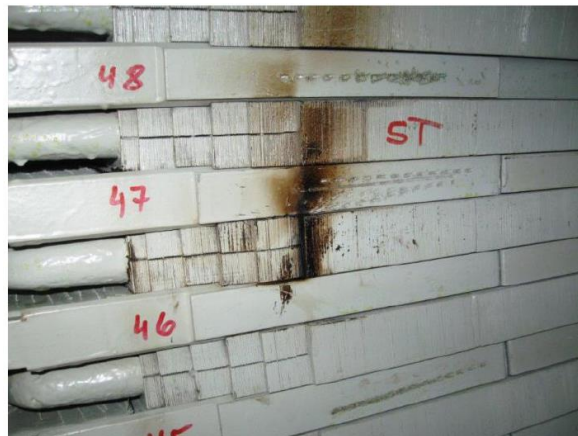
Obr. 2.3: Izolace ve formě bílého prachu, sedřená z čel vinutí třením a vibracemi (vlevo); průraz izolace statorového vinutí vzniklý v důsledku vibrací čel (vpravo) [5]
