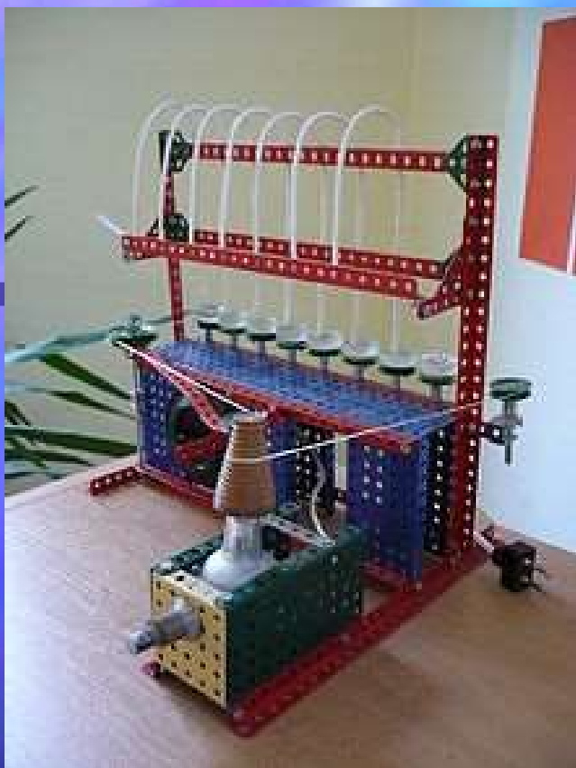
Zařízení na odstředivé odlévání kontaktních čoček z hydrogelu (vystaveno v NTM)
