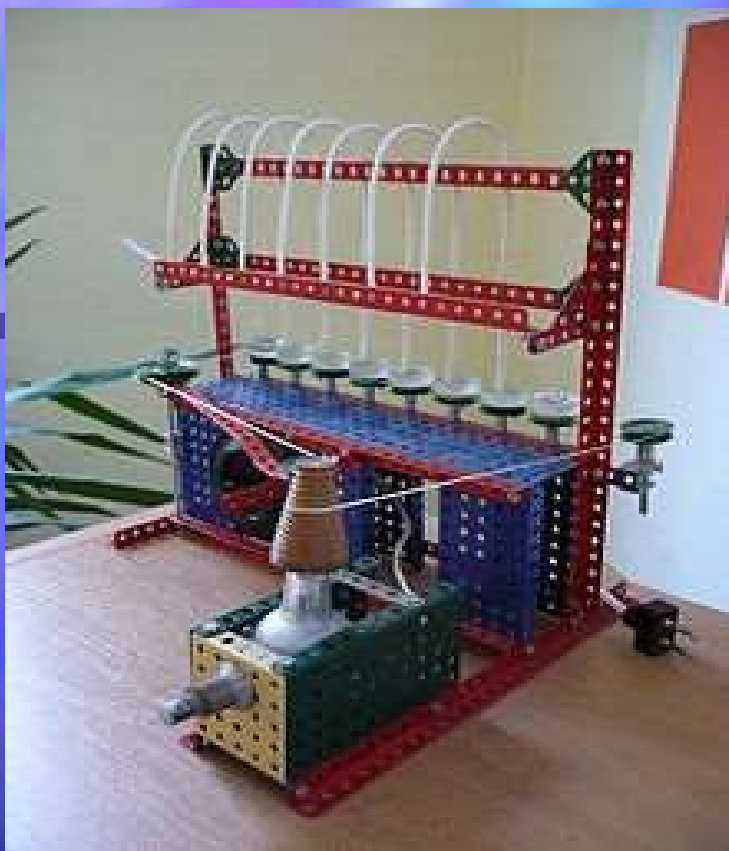
Zařízení na odstředivé odlévání kontaktních čoček z hydrogelu (vystaveno v NTM)
