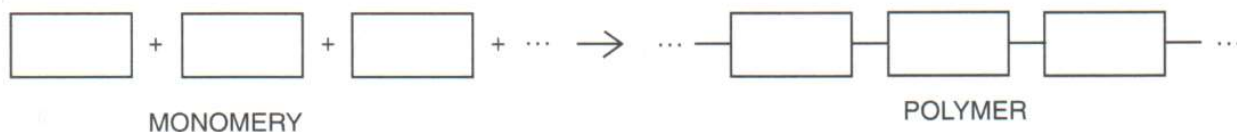
Obr. 99: Schematické znázornění polymerace
