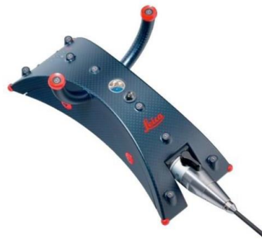
Obr. 20 Dotyková sonda T-Probe II [20]
